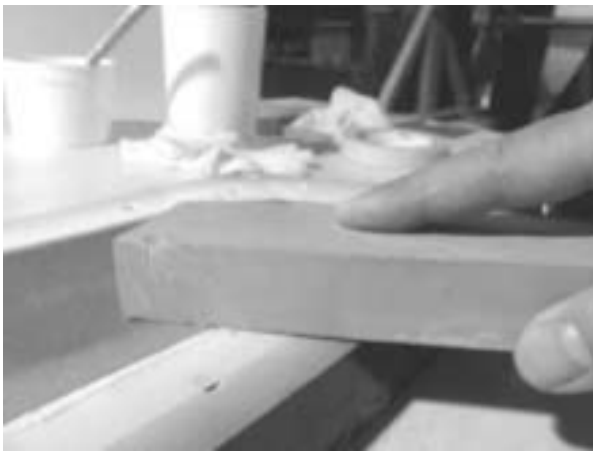
Bild 11 - Mit einem Schleifklotz werden überstehende Sandwich-Lamine für den Verstärkungsvorgang hergerichtet, indem diese Formrandzonen niveaugeschliffen werden.
