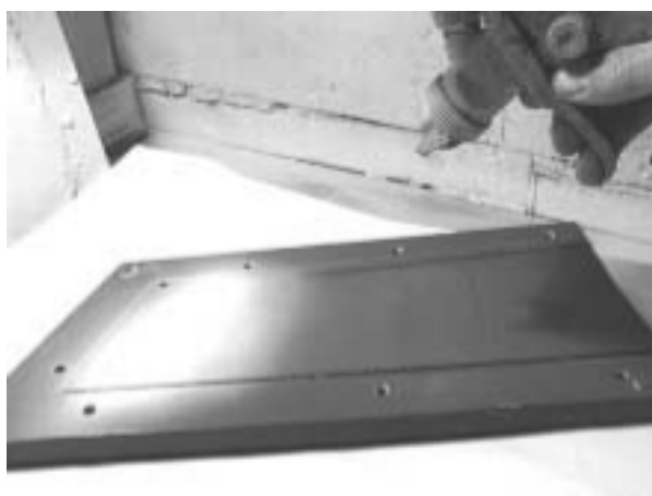
Bild 1 - Auf die mit entsprechenden Trennmitteln versehene Negativ-Form-Oberflächen haben wir unser Polyester-Vorgelat weiß appliziert (hier im Spritzvorgang mit Styrol verdünnt). Diese Schicht muß gut härten (1-2 Tage bei mind. 20 °C).
