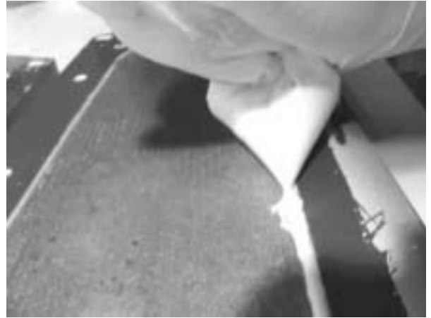
Bild 12 - Ein Gemisch aus Epoxid-Laminierharz EPL 285/EPH 285 und Microballoons Q-21 wird auf pastöse Konsistenz angerührt, in einen PE-Beutel gegeben, dem dann die Tütenspitze abgeschnitten wird und die Gemischraupe auf den gehärteten, geschliffenen Sandwich-Rand beider Formhalbschalen gleichmäßig ausgedrückt wird.
