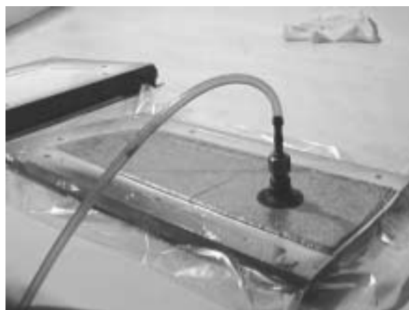
Bild 9 - Darauf wird ein Zuschnitt Absaugvlies aufgelegt und alles in den PE-Foliensack eingeschoben und das Vakuum wie vorher beschrieben angelegt.
