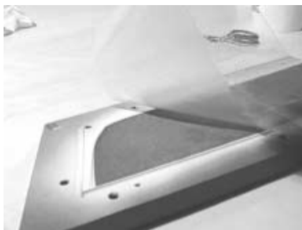
Bild 8 - und noch im nassen Zustand laminatseitig, ohne die Lochfolie wegzunehmen, auf den fest anliegenden PVC-Hartschaum angewalzt.
